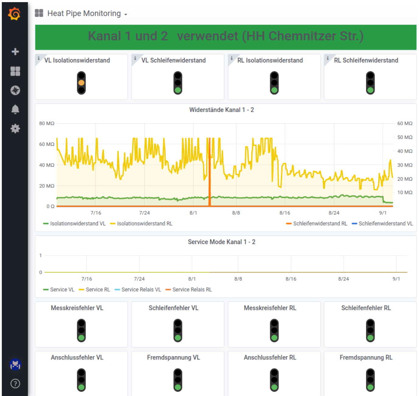
Visualisierung des Isolationswiderstands (Vor-/Rücklauf) in der Leitstelle
